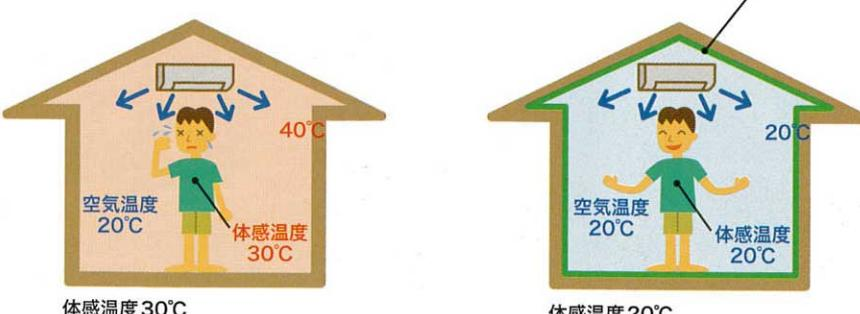
室内空気温度が20°Cで、壁・天井の表面温度が40°Cである左図の部屋の体感温度は30°Cとなります  $[(20°C + 40°C) \div 2 = 30°C]$ 。
