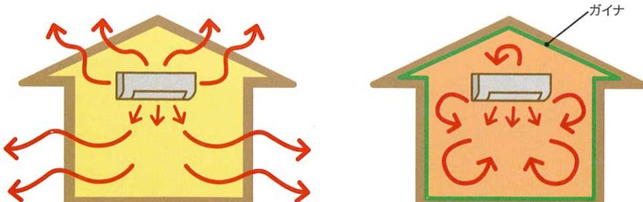
室内空気温度がいくら高くなっても、壁・天井の温度が低ければ、熱は壁・天井から逃げます。
