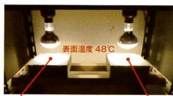
▲それを実験機に設置し、一般塗料塗布コンクリートの表面温度が 48°C になるようライトを照射して、それぞれの裏面温度を計測。
