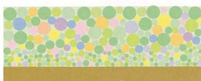
ガイナは、特殊セラミック層で構成されています。この特殊セラミックが、周辺温度に適応する性質があり、その結果、熱の均衡化をもたらし、熱の移動を抑える働きをします。
