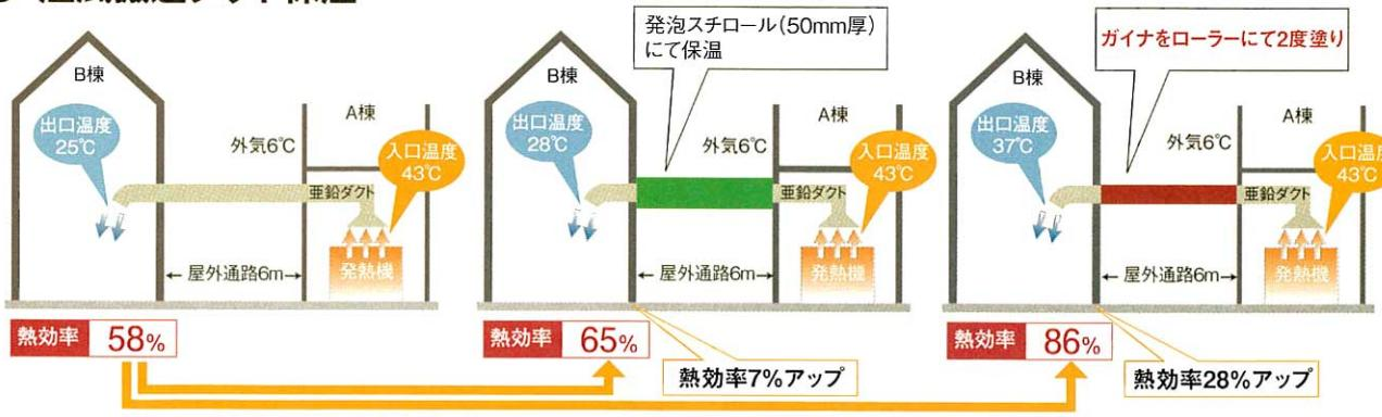
ガイナは対象物の形状にかかわらず、隙間なく均一な断熱層を形成し、効果的な断熱を可能とします。
