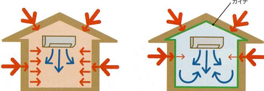
室内空気温度がいくら低くなっても、壁・天井の温度が高ければ、熱は室内へ侵入します。
