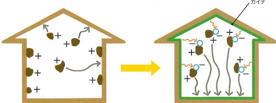
一般的に空気中を浮遊しているホコリ、チリ、花粉などの汚濁物質は、プラスの電気を帯びることで浮遊しています。また、これらの汚濁物質は、室内の壁や天井に静電付着します。
